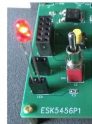
LEDは電圧ではなく電流で規定されます。そのため電流制限抵抗が必要ですが、この基板にはすでに1.8kΩが接続されているので、直接、コネクタに挿入しても問題ありません。
